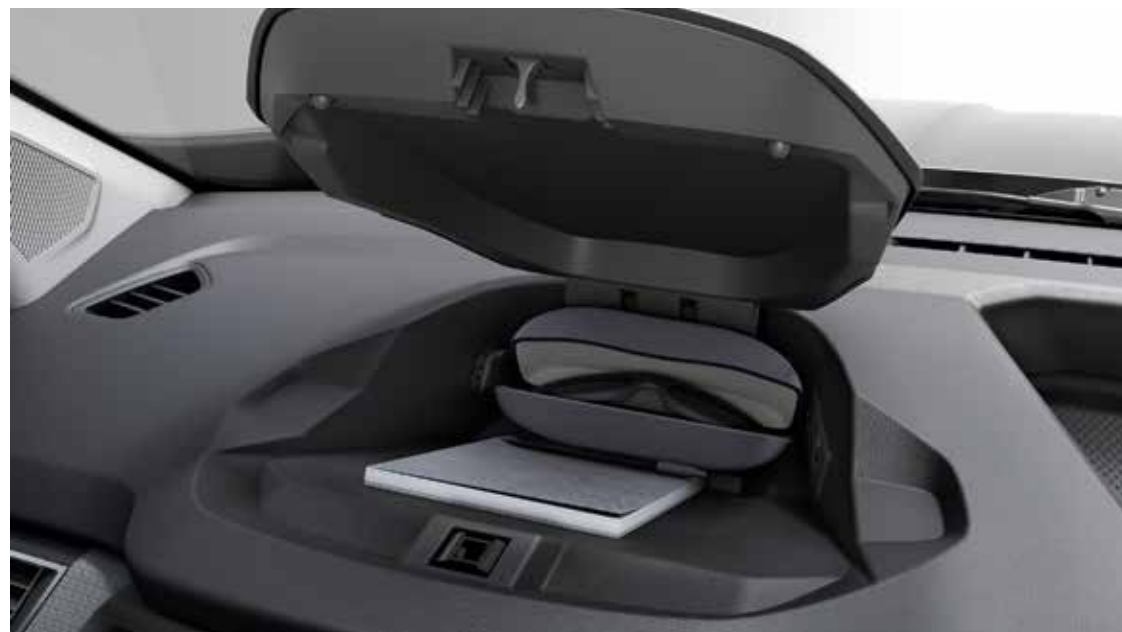
κλειστός χώρος αποθήκευσης πάνω από το τιμόνι με 3 παροχές (12V και 2 USB)
